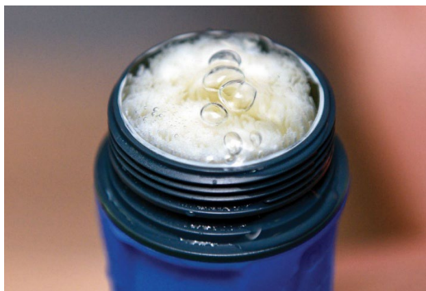
Obrázek B (poškozené vlákno / BROKEN FIBER): souvislý proud bublinek z jednoho místa.
